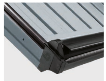
La zoccolatura inferiore in abs, di colore nero, ha una altezza di 50 mm, tappi laterali di chiusura e un profilo di alluminio all'interno. Il risultato estetico pregevole garantisce anche una perfetta chiusura tra anta mobile e pavimento. Optional.
